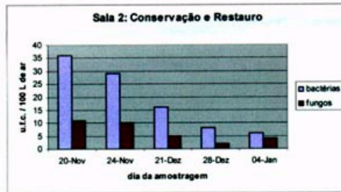
FIGURA 2. - Efeito do aparelhos na manutenção do nível de carga microbiana (bactérias e fungos) existente na sala 2 (Conservação e Restauro). No dia 24 de Novembro de 2000 foram ligados os aparelhos. Cada ponto representa a média de 3 contagens.
